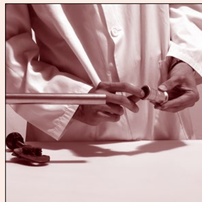
Fig. 23 Verifica della presenza e del posizionamento degli o-ring Checking the presence and positioning of o-rings
