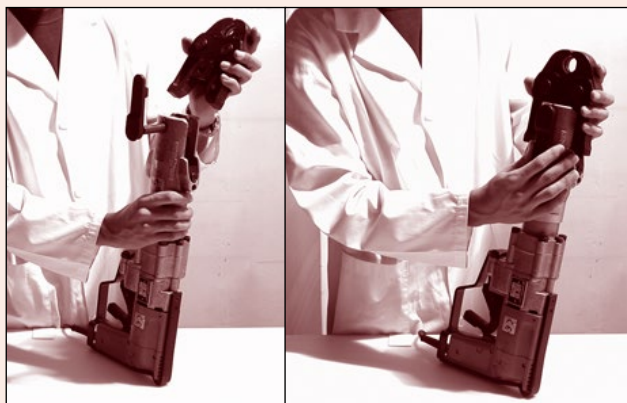
Fig. 27 Attrezzaggio delle pressatrici Pressing tool assembly
