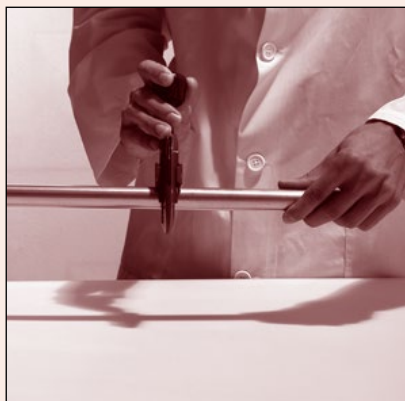
Fig. 21 Taglio dei tubi Pipe cutting
