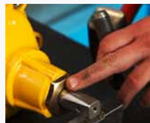
Dato og serienummer er stempet på gasventilernes spindel
