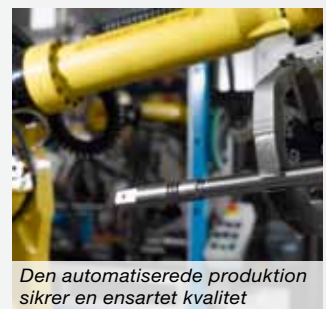
Spindler til gasventiler (3) poleres for at sikre fuld tæthed
