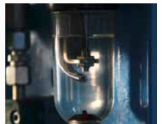
Et infrarødt øje kontrollerer automatisk under tryktesten
