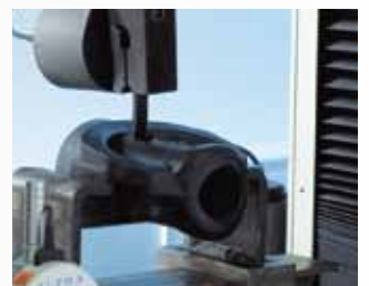
Et tyndt lag gummi skal forblive på kernen efter afrivningsstesten
