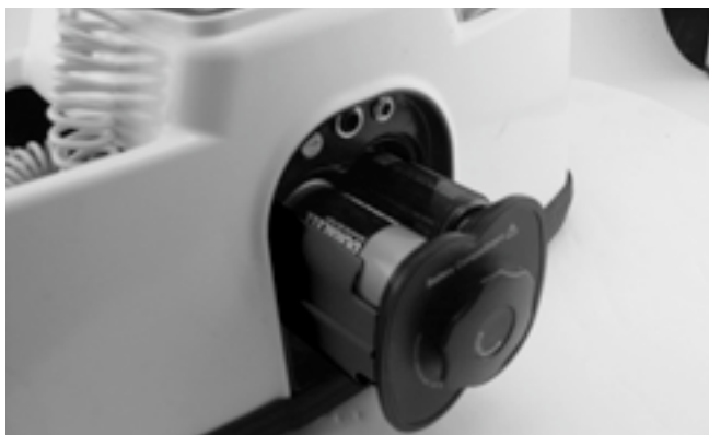
Figur 6 – Fjernelse af batteriholderen
