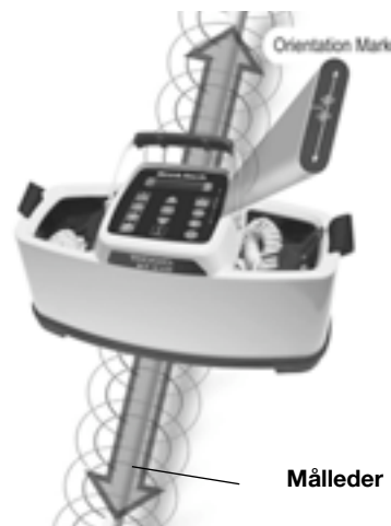
Figur 13 - Placering i forhold til ledningen - Induktiv funktionstilstand
