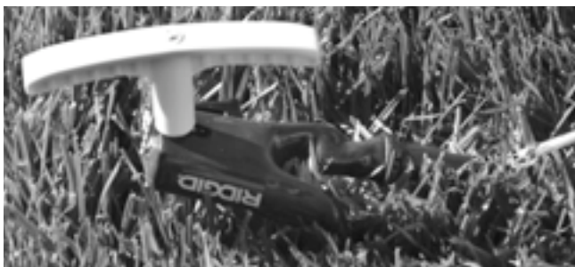
Figur 7 - Tilslutning af kabel til jordspyd
