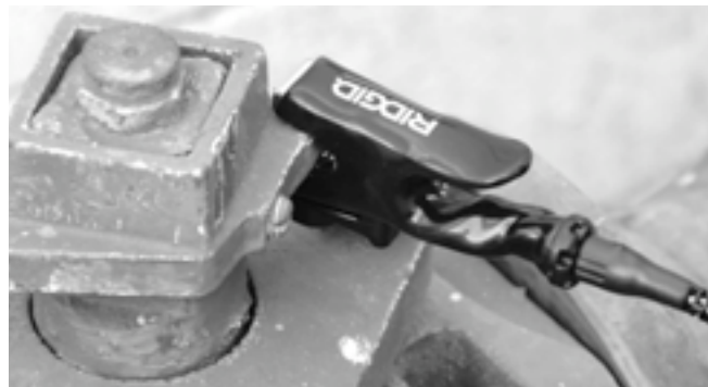
Figur 8 - Tilslutning af kablet til mållederen.
