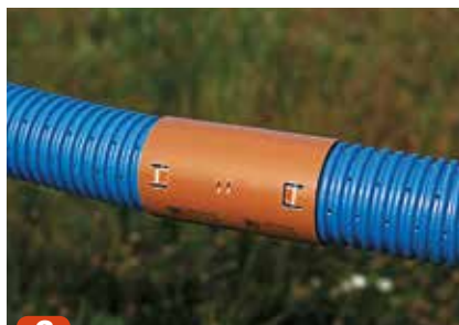
2 Pres den fri rørende helt i bund i dobbeltmuffen for at opnå en trækfast samling.
