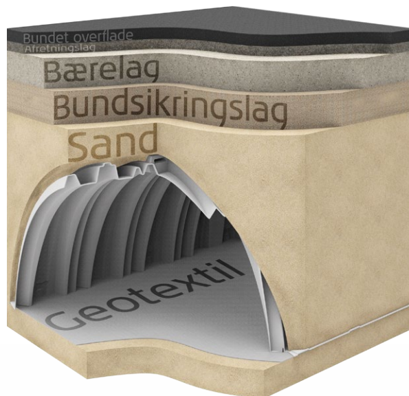
Eksempel på påfyldningslag bestående af sand
