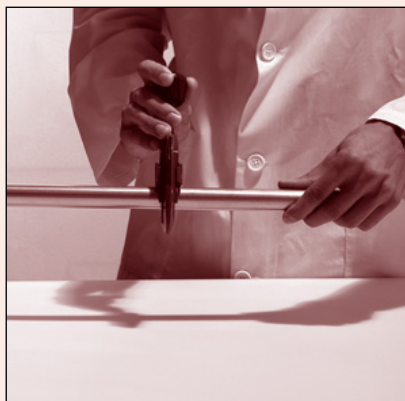
Fig. 21 Taglio dei tubi Pipe cutting
