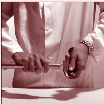
Fig. 22 Sbavatura dell'estremità dei tubi Pipe-end deburring
