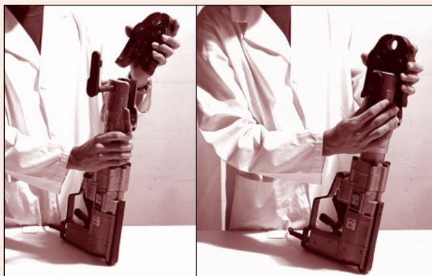
Fig. 27 Attrezzaggio delle pressatrici Pressing tool assembly
