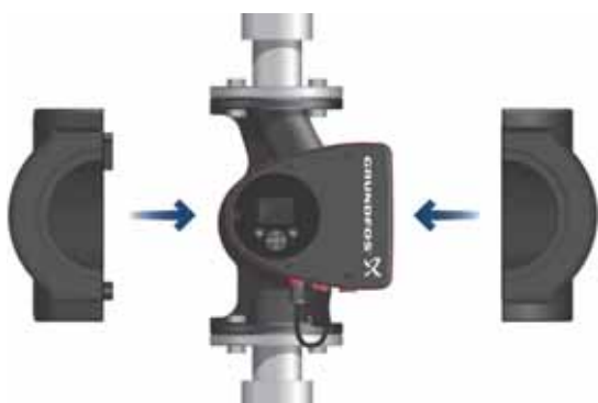
Fig. 45 Montering af isoleringsskaller på en MAGNA3-pumpe
